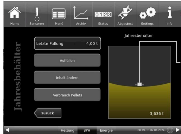
Abbildung 8: Display bei eingebautem Pellet-Maulwurf-System (Beispiel mit leeren Jahresbehälter)
